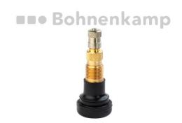
Agrar-Felgenventil TR 618 Wasserventil Snap in, gerade, 57 mm lang für Ventilloch O 15.7 mm, max. 10.5 bar
